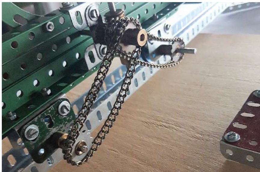
Foto n° 4. Vista de las cadenas para el arrastre del puente
